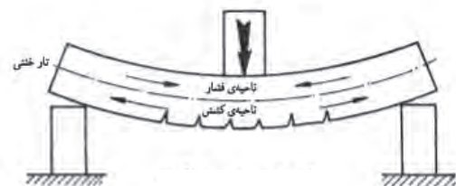
شکل ۱-۱۴ - تیر بتنی پس از بارگذاری ▲
